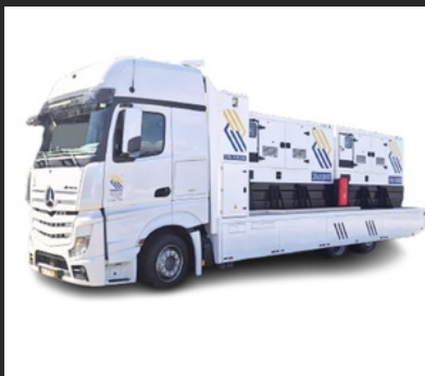
GERADORES EM SINCRONISMO 2X180 KVAS
